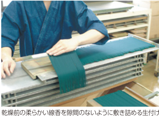
乾燥前の柔らかい線香を隙間のないように敷き詰める生付け
